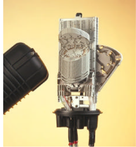
Positionnement des câbles en « épi »
