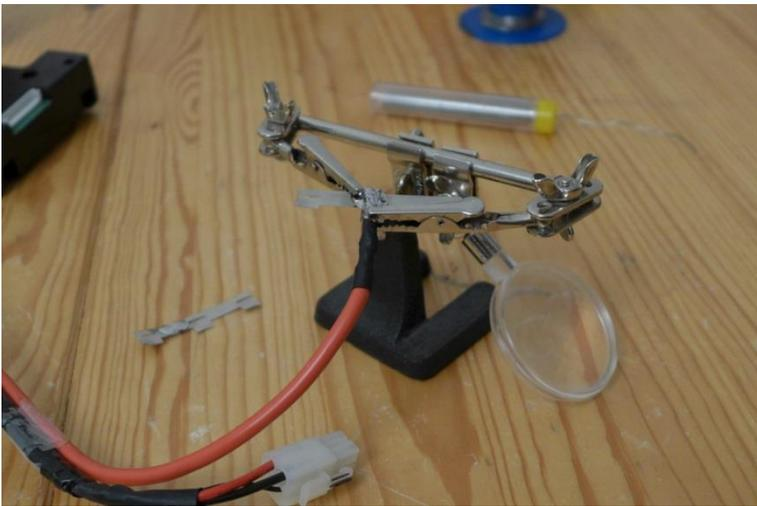
4. Souder par point la bande nickel intermédiaire du **câble noir** sur la bande nickel du pack (**côté -**). Ne pas lésiner sur le nombre de points de soudure, en respectant un espacement régulier et en laissant refroidir.
