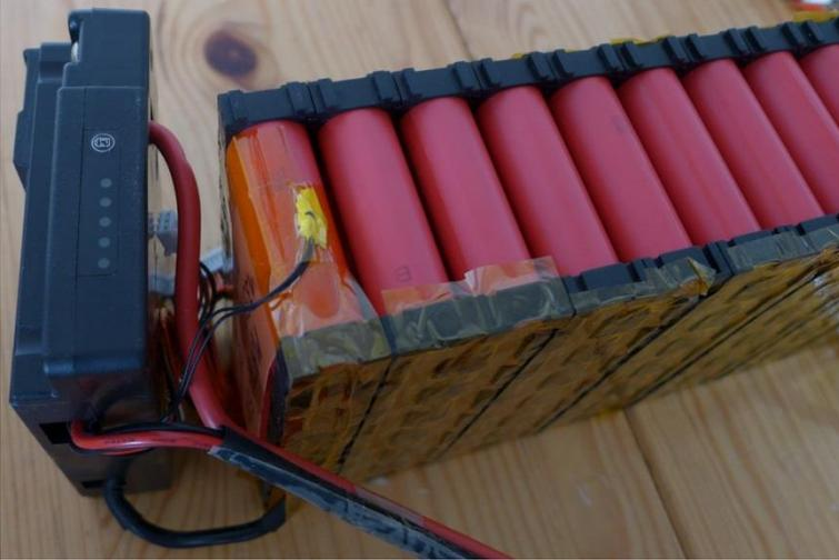
3. Placer avec précaution le nouveau pack d'accus dans le **couvercle inférieur** du boîtier, en vérifiant qu'aucun fil n'est écrasé ou tendu.
