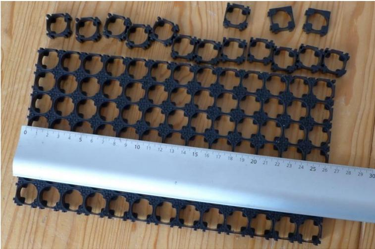
2. Couper les ergots de fixation à l'extrémité des supports, qui pourraient gêner l'insertion dans le boîtier. Utiliser une bonne pince coupante, puis finir avec un gros cutter Dexter, un couteau de boucher, une lime à ongles, ou tout autre arme de psychopathe 😊
