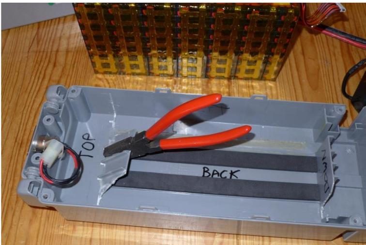
19. Sur les **câbles d'alimentation** (rouge et noir), couper pour ôter les lames conductrices, dénuder les câbles et ajuster la longueur en fonction des soudures prévues (voir les photos).
