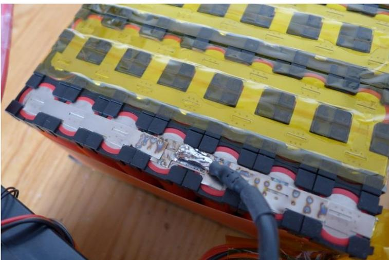
5. Souder par point la bande nickel intermédiaire du **câble rouge** sur la bande nickel du pack (**côté +**).
