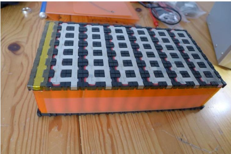
4. Oter le scotch de protection sur la **1ère rangée** et poser la **bande de Nickel** correspondante dessus. Nettoyer les accus si besoin.
