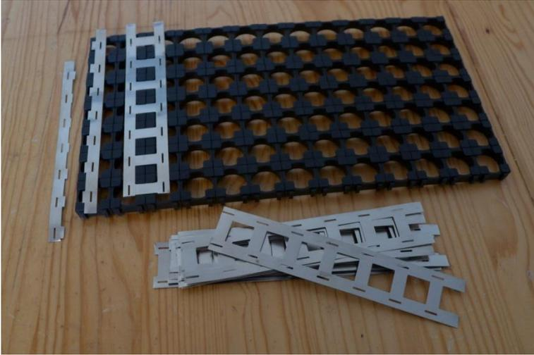
2. Pour la **dernière rangée à chaque extrémité du pack**, couper une bande en 2 dans le sens de la longueur, en gardant une patte pour la soudure. Couper les morceaux inutiles.
