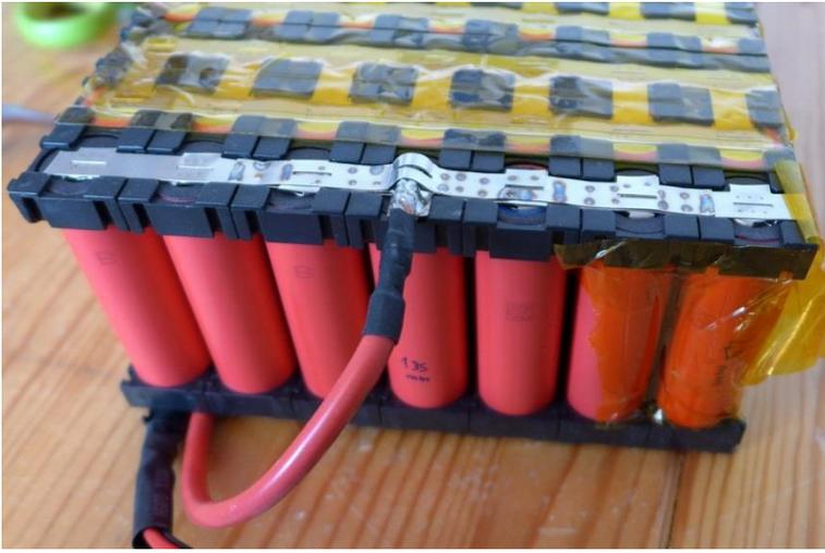
6. Isoler les **câbles d'alimentation** et coller soigneusement du **scotch Kapton** sur toutes les zones conductrices.
